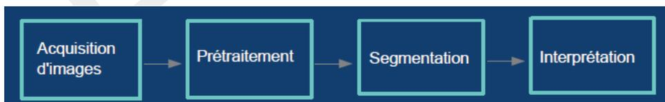
Figure 1.1 Etapes d'un système de vision par ordinateur.
